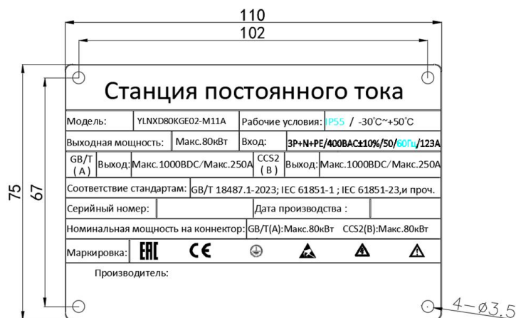
Рисунок 6 – Пример заводской таблички.
